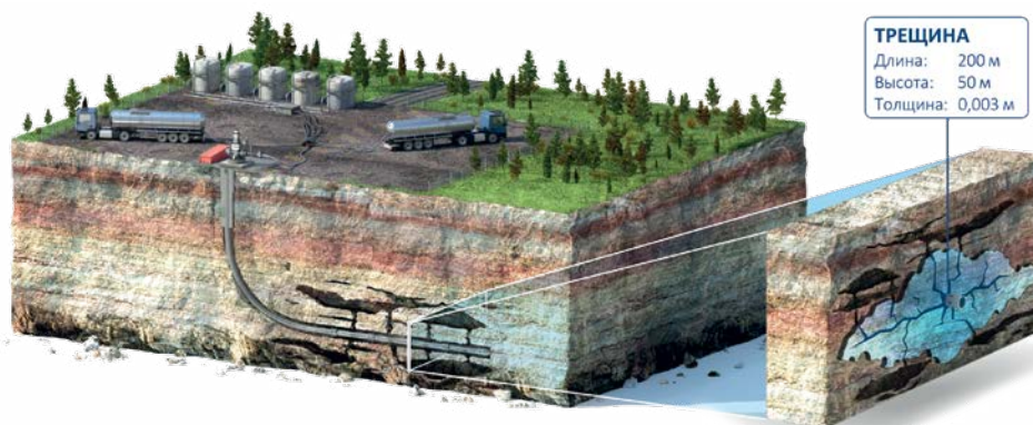
Рис. 1. Скважина с многостадийным ГРП
