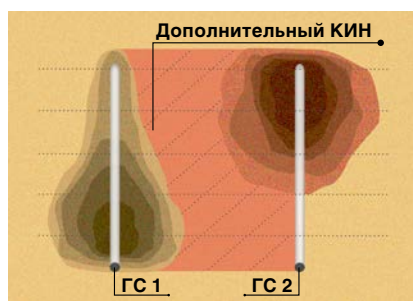
Рис.4. Локализация остаточных запасов углеводородов на основании маркерной диагностики работы интервалов
